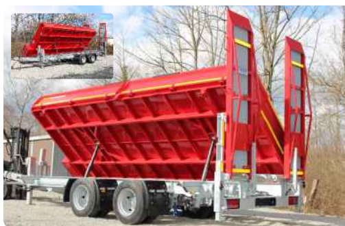
Typ 896/14000 mit verzinktem Chassis, verlängerter Kipperbrücke auf 6,20m, geteilten Bordwänden, großer Stahl-Staukasten an der Stirnwand
