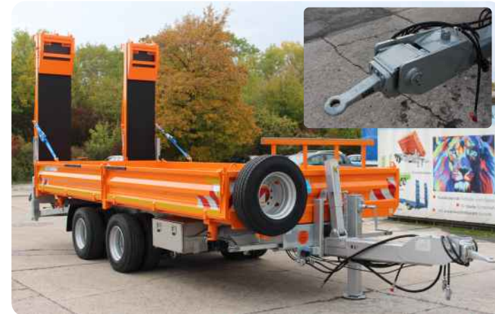
Typ 899/18000 mit verlängerten Rampen mit HEGE-Gummibelag, 1x klappbar, motorhydraulisch absenkbar, Edelstahlkiste, Ablagebock für Baggerschaufel, Ersatzrad und Schwenköse 40/50mm
