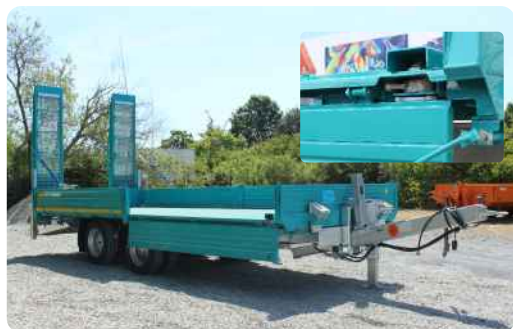
Typ 896/14000 mit Containerverriegelungen „TwistLock“ mit Abdeckung, verzinktem Chassis, verlängerter Kipperbrücke und geteilten Bordwänden
