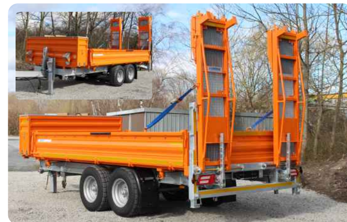
Typ 892/11900 mit Breitbereifung 355/60R18, doppelter Staukasten, auf 3,00m verlängerte Rampen, 1x klappbar, verzinktes Chassis, Voll-LED Lichtanlage, Gitterroste in den Rampen
