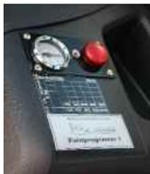
Ein Manometer zum Ablesen des Drucks und eine Störungsleuchte wird im Fahrerhaus angebracht.
