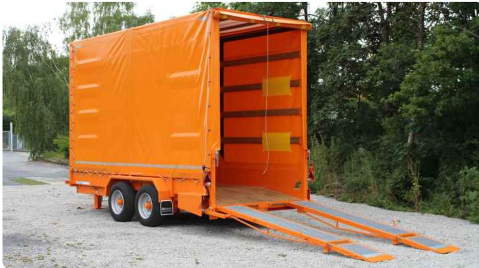
Typ 554/8900 mit Planenaufbau mit verlängerten und klappbaren Rampen, dadurch Auffahrwinkel bei 9°
