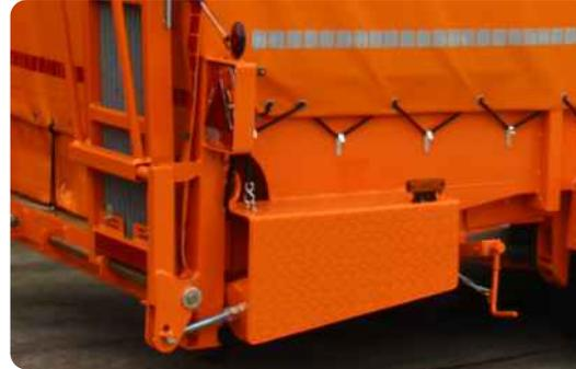
Rampenfederhebwerk (elektro-hydraulische Rampenheber möglich!)
