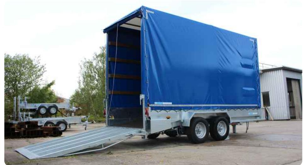
Typ 558/11900 mit Planenaufbau und geschlossener Ladebordwand, feuerverzinkt
