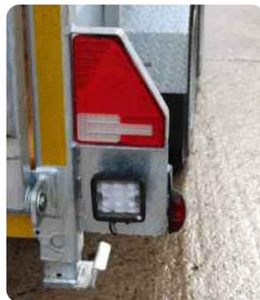
Voll-LED-Lichtanlage mit zusätzl. Rückfahrcheinwerfern
