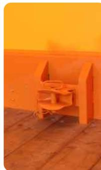
Rangier- oder Bolzenkupplung an Stirnwand (mit Adapter)
