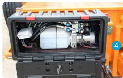
Elektro-Hydraulik-Kompaktaggregat, 24V, mit 2200W Leistung, für die Bedienung der hydraulischen Rampenheber, incl. Fernbedienung! Verbaut in einer Kunststoff-Werkzeugkiste.
