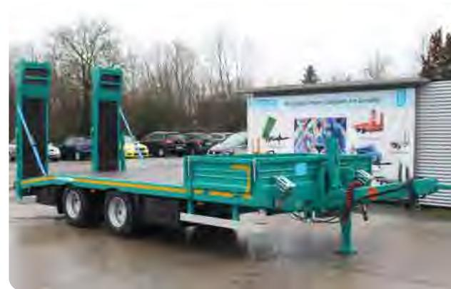
HEGE Belag in Rampen u. Auffahrsschräge, Rampen verlängert u. geteilt, abgetrennte Ladefläche mit abnehmbaren Bordwänden
