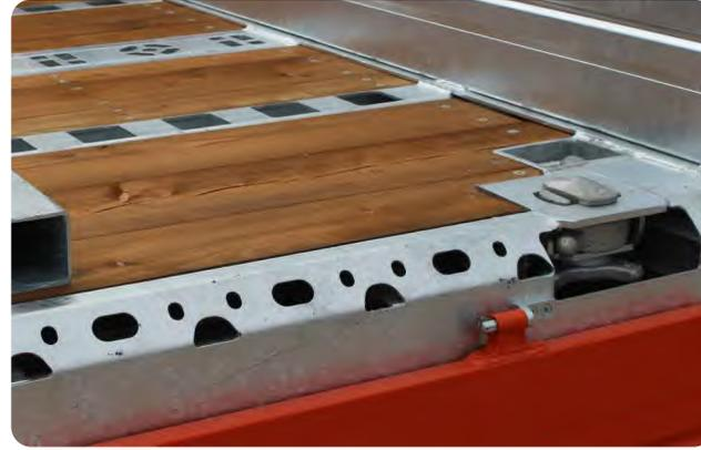
Außenprofil doppeltes Lochbild (2000daN Zurrkraft) mit mittlerer Zurrleiste VarioO, Container-Verriegelung und Querrohranschlag
