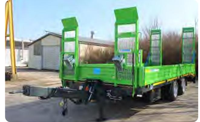
Mit Überfahrrampen auf das Zugfahrzeug und hydraulisch höhenverstellbarem Zugbaum, Stirnwand und Eckpfosten steckbar
