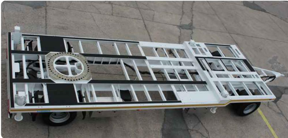
Auch als Zweiachs-Fahrgestell mit Sonderanbindung oder Stützen möglich
