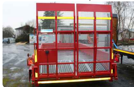
geschlossene Ladebordwand, Gleitschutzroste auf der Schräge
