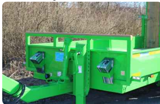
Auflagebock auf der Stirnwand für Baggerschaufel
