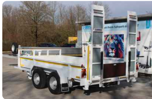
Gitterroste in den Rampen - mit zusätzlichen Gasdruckdämpfern
