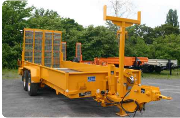
AWST 569/11900 mit Ablage für Fräsenladeband u. Schwenköse
