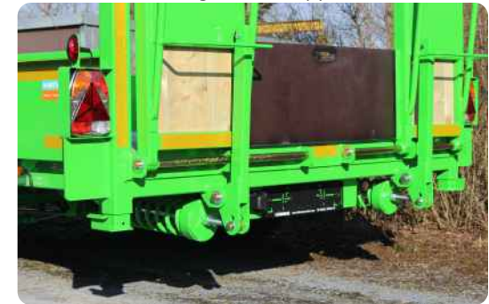
Rampenfederhebewerk anstelle Gasdruckdämpfer
