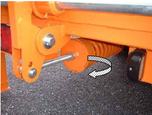
Verstellung der Vorspannung bei Stahlrampen
