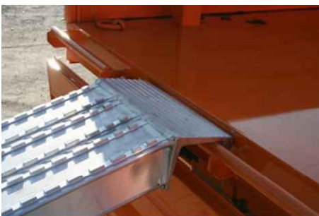
Korrekt eingehängte Auffahrrampe
