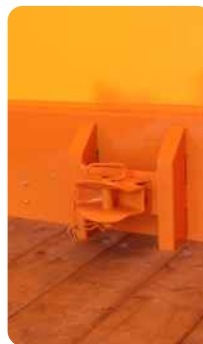
Rangier- oder Bolzenkupplung an Stirnwand (mit Adapter)
