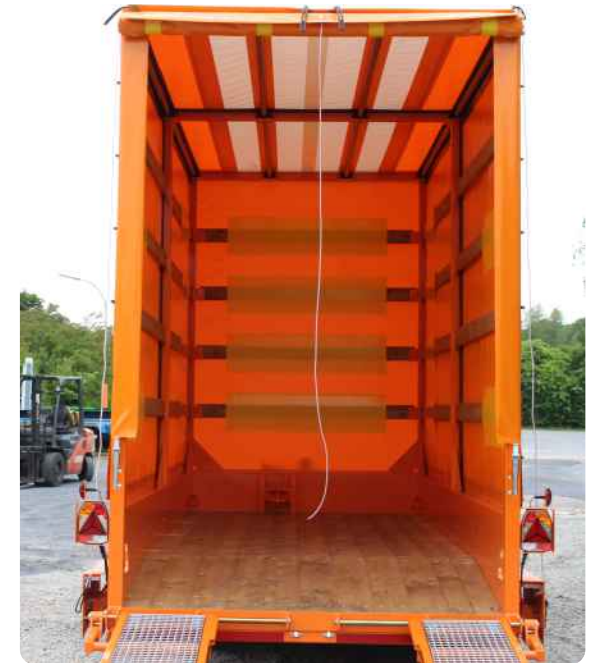
Planenaufbau: Verdeckgestell aus Rohr, mit Taschen für Einstecklatten, Mittelstützen feststehend, oben verzinkte Planrohre, Plane aus PVC mit Heckrollo, im RAL-Ton nach Wunsch. Maße gem. Angabe. Hier: Lichte Innenhöhe bei 3,0m
