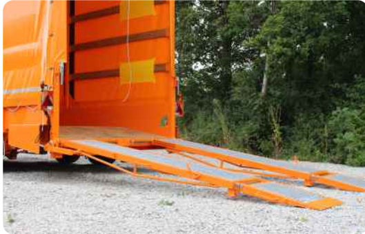
Rampenverlängerung auf 3,20m, geklappt
