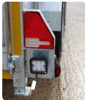
Voll-LED-Lichtanlage mit zusätzl. Rückfahrcheinwerfern
