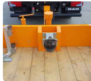
Rangier- oder Bolzenkupplung an Stirnwand (mit Adapter)
