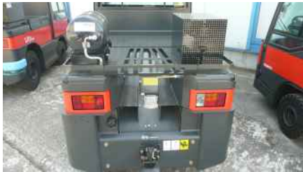
Pneumatic connector „Duomatic“
