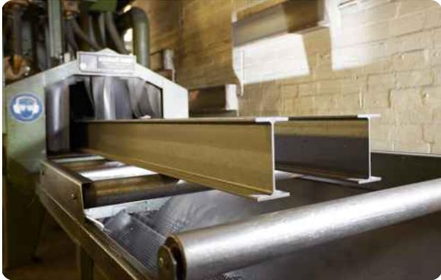
1. Alle Stahlbauteile werden vor der Verarbeitung gestrahlt
