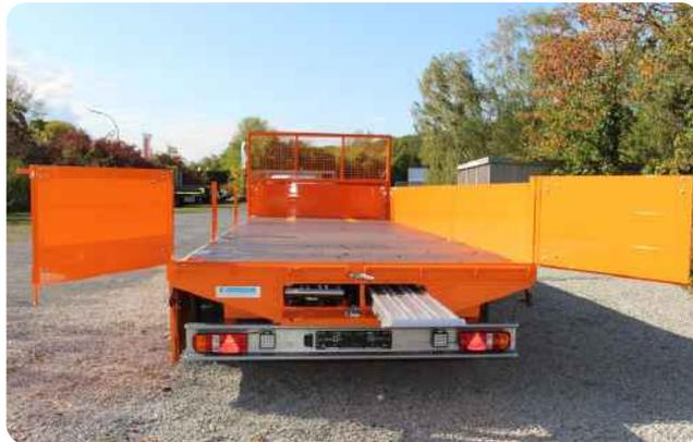
Mit Flügeltür und eingeschobenen Laderampen (verschiebbar), dreigeteilte Alubordwände, zusätzliche Rückfahrcheinwerfer
