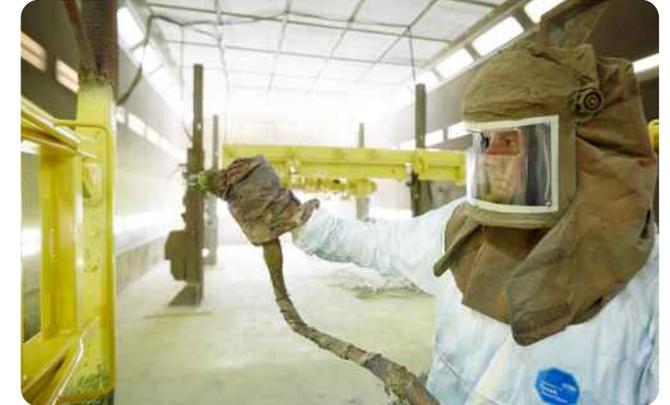
3. Grundierung mit Zinkphosphatanteil (verhindert Korrosionsunterwanderungen bei Beschädigung), anschließend Auftragen der ersten Lackschicht
