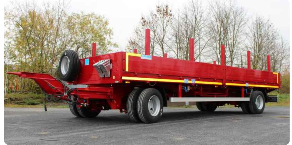
Zweiachs-Drehschemelanhänger mit Alubordwänden 400mm hoch, seitlichen Steckungen, Ersatzrad, Luftfederung, Halter unter der Ladefläche für Rungen, durchgängig gerade Ladefläche
