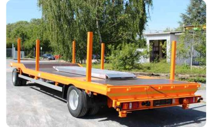
Mit Kröpfung über dem Drehschemel, losen Alu-Verladeschienen zum Einhängen auf der Heckwelle, Steckrungen und teleskopierbarer Beleuchtung für Überlänge
