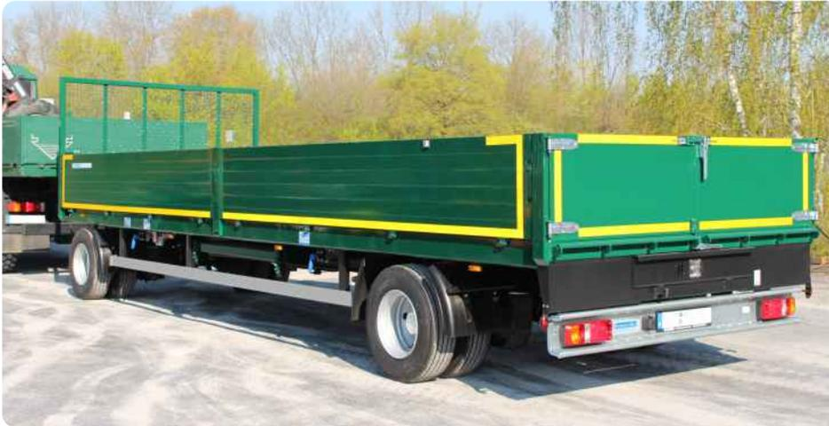
Zweiachs-Drehschemelanhänger mit durchgängig gerader Ladefläche, eingeschobene Laderampen mit 9t Traglast, Flügeltür hinten, am Heck Welle zum Einhängen von Alu-Verladeschienen, Rungen unter der Ladefläche verstaut
