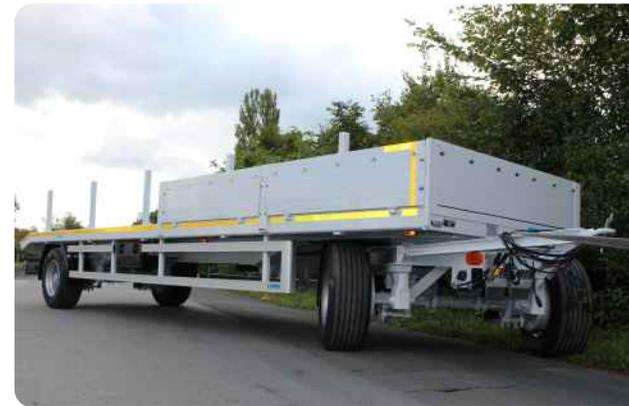
Breitbereifung und Alubordwände vorne, Netzhaken, Werkzeugkiste untergebaut
