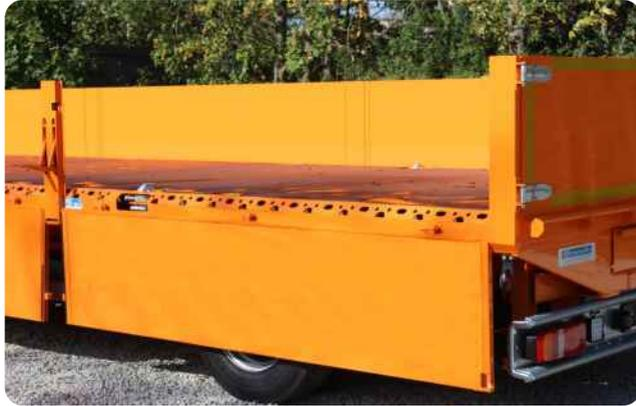
Außenprofil mit doppeltem Lochbild und Containerverriegelungen an Wunschposition, Alu-Bordwände 500mm hoch
