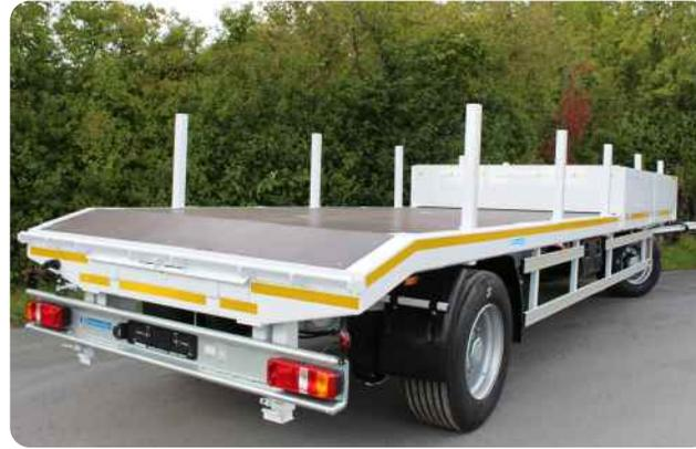
Steckbare Rungen, eingeschobene Rampen, abgeschrägtes Heck, Abtrennung vordere Ladefläche mit Alubordwänden
