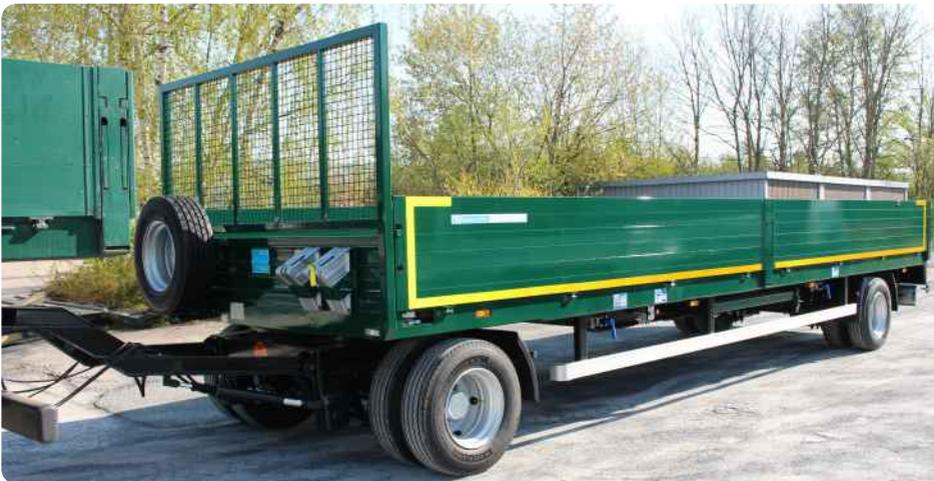
Stahl-Stirnwand und Stirnwanderhöhung aus Wellgitter, Ersatzrad, mit Containerverriegelungen vorne, Alubordwände 500mm hoch, mittig geteilt
