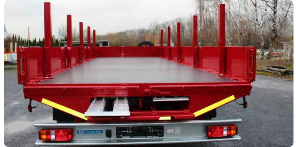
Alurampen unter der Ladefläche eingeschoben, abschließbar durch Klappe, Flügeltür, 5 Paar Steckungen seitlich
