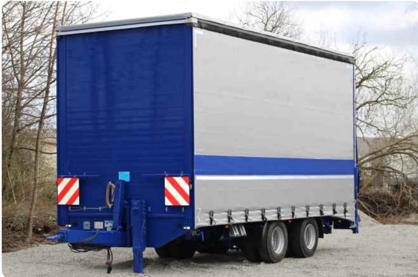
Mit Schiebepanenaufbau, Stirnwand aus Aluminiumprofilen, Warnpaket (ausziehbare, beleuchtete Warntafeln, Anschluss Rundumkennleuchte)
