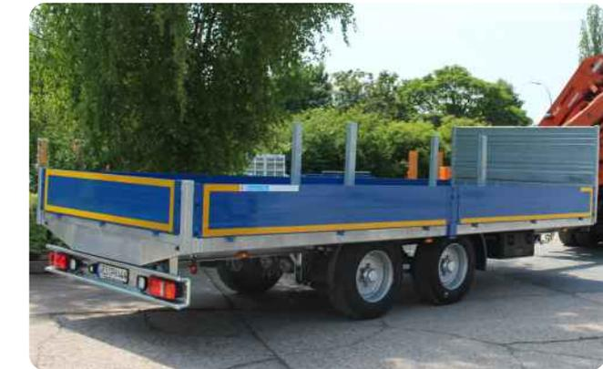
Chassis feuerverzinkt, erhöhte Stahlstirnwand auf 80cm, Rungen an Wunschposition steckbar, zusätzliche LED-Rückfahrcheinwerfer, geteilte Seitenbordwände
