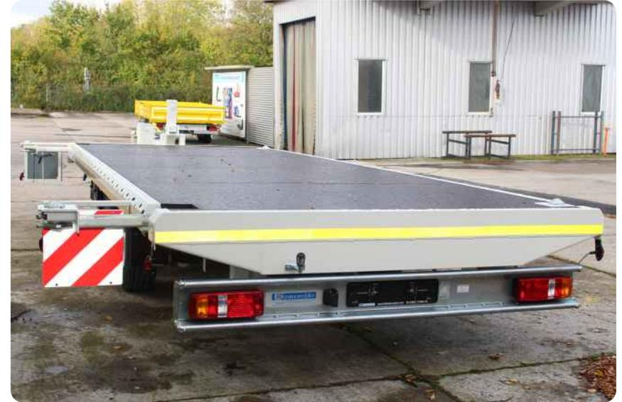
Als Plateauanhänger für Containertransporte mit teleskopierbaren Containerverriegelungen und Warnpaket (ausziehbare, beleuchtete Warntafeln, Anschluss Rundumkennleuchte)
