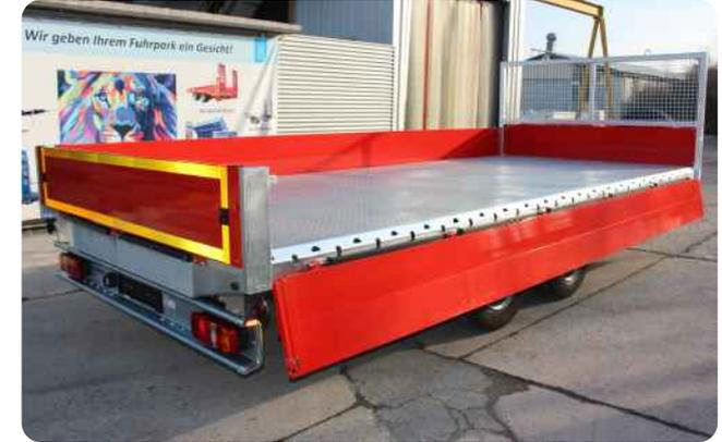
Chassis feuerverzinkt, Außenprofil mit doppeltem Lochbild, Aluminiumbordwände 400mm hoch, Stirnwanderhöhung aus Wellgitter, Tränenblechboden feuerverzinkt
