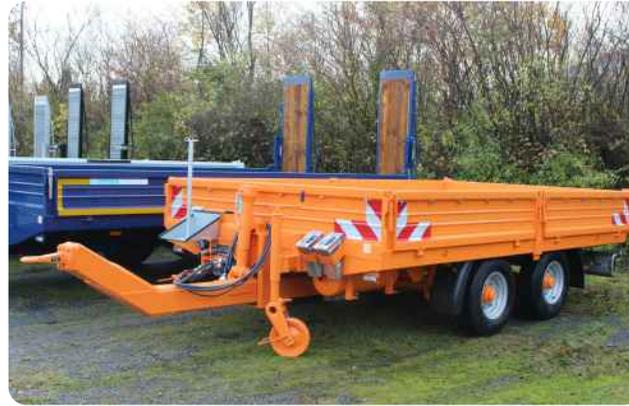
Typ 745/5000: mit Stützrad, Stahlbordwänden, Netzhaken, Warnmarkierung, Halterung für Pylonen, geteilte Bordwände
