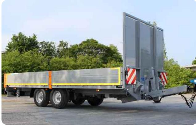
500mm hohe Aluminium-Bordwände, geteilt, mit Stirnwanderhöhung auf 2 m, mit Warnpaket (beleuchtete Warntafeln, Anschluss Rundumkennleuchte), Containerverriegelungen, Luftfederung
