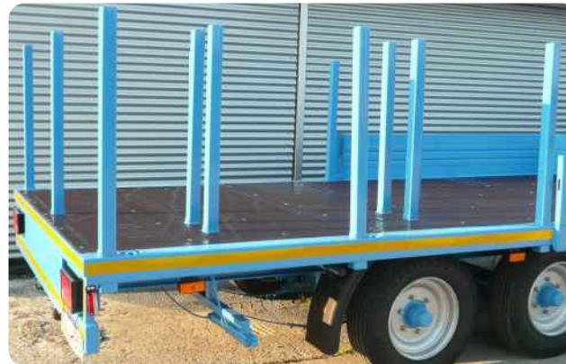
Rungen an Position gemäß Angabe steckbar, mit Stahlbordwänden an vorderer Hälfte der Ladefläche
