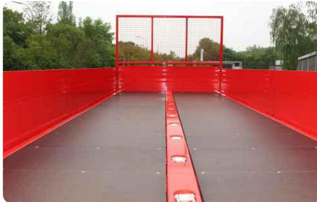
Zurrleiste mittig mit drehbaren Zurrmulden, 4000 daN belastbar
