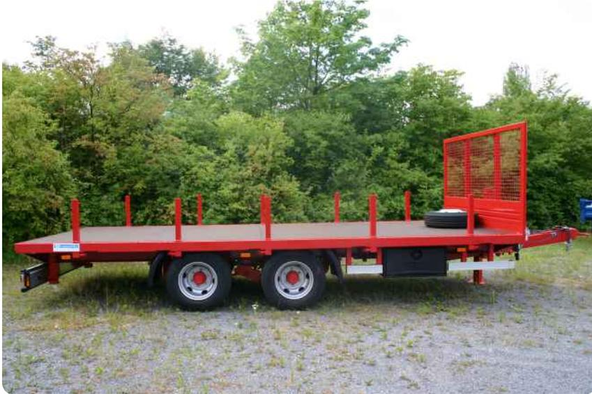
Mit Steckungen seitlich, Werkzeugkiste u. Stirnwand aus Welldrahtgitter
