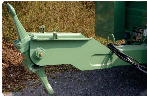
Schwenkopf mit wahlweise 40mm und 50mm Zugösen
