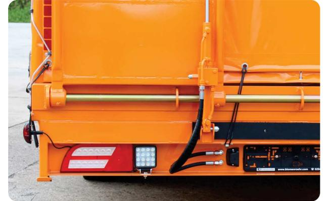
Voll-LED-Lichtanlage 24V, zusätzliche LED-Rückfahrcheinwerfer, Rampen verbreitert auf 80cm, ganz zusammenschiebbar, mit Gasdruck-Rampenhebern
