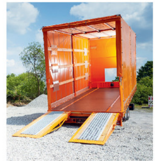
Ein echter Helfer für die Baustelle: ankippbarer Blomenröhr-Tieflader mit nur neun Grad Steigung
