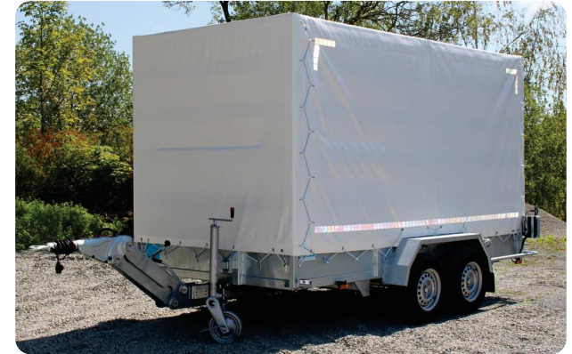
Aufbau mit Plane, verstärktem Stützrad und höhenverstellbarer Zugdeichsel
