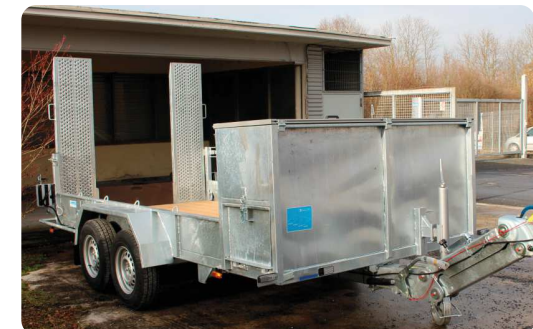
doppelter Staukasten - von oben zu beladen über Deckel und seitlich durch Klappen
