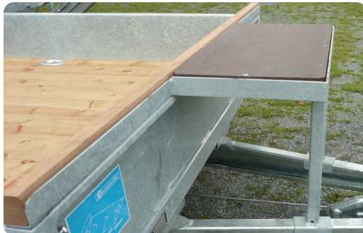
Ablage Baggerschaufel - U-Eisen mit Hartholz auf Stirnwand u./oder Ablagetisch vor der Stirnwand
