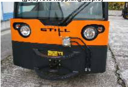
Druckluftleitung auch nach vorne gelegt
