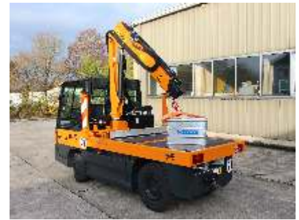
Kran PC2700 aufgebaut ohne Bordwände
