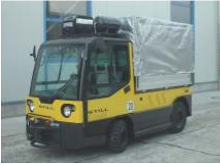
Druckluftbremsanlage auf Dach montiert
