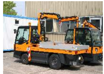
Kran PC1500 mit niedrigen Bordwänden
