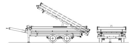
Achsen: Gigant-Schnellläuferachsen mit S-Nockenbremse und wartungsfreiem Parabelfederaggregate mit Lastausgleich
