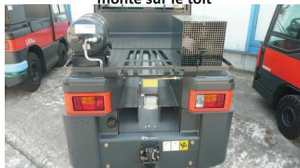
Prise d'air comprimé Duomatic
