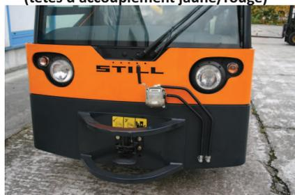
Conduite d'air comprimé également placée vers l'avant
