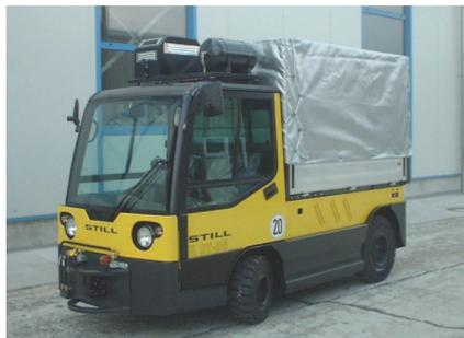
Système de freinage à air comprimé monté sur le toit
