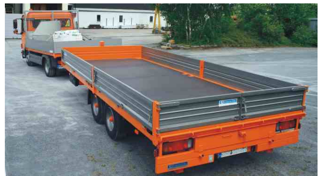
Ges.-Gew. 11900 kg , Bestellnr. 695/11900, NL ca. 9400 kg, Lademaß ca. 5000x2450 mm, Ladehöhe unbeladen ca. 880 mm, Zubehör: Zweifarbenlackierung, Ladeflächenverlängerung, geteilte Bordwände und steckbare Mittelrunge
