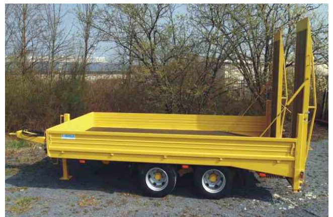
Ges.-Gew. 10500 kg , BestellNr. 663/10500, NL ca. 7800 kg, Lademaß ca. 5000x2450 mm, Ladehöhe unbeladen ca. 880 mm, Zubehör: steckbare Eckpfosten hinten
