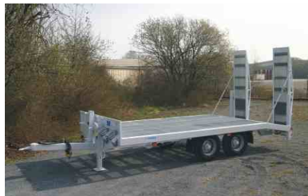
Gitterrost in der Ladefläche, Zurrpunkte in Ladefläche
