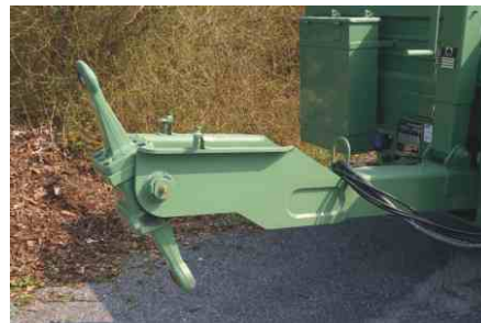
Schwenkkopf mit wahlweise 40mm und 50 mm Zugösen
