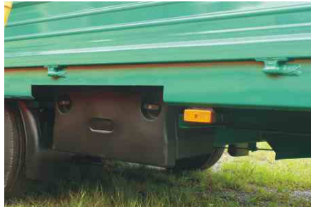
Kunststoffkisten seitlich unter dem Fahrzeug montiert
