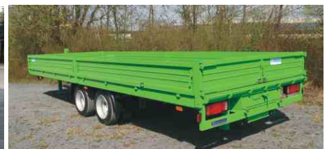
Für den Transport von Abrollcontainern in der Ausführung Zwillingsbereifung
