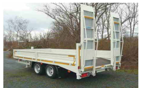
Verzinkte Gitterroste anstelle Holzbelag in den Rampen
