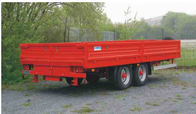
Ges.-Gew. 6900 kg , Bestellnr. 691/6900, NL ca. 5000 kg, Lademaß ca. 4500x2450 mm, Ladehöhe unbeladen ca. 850 mm, Zubehör: Ersatzrad mit Halter, geteilte Bordwand + steckbare Mittelrunge
