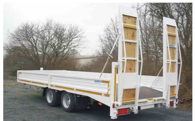
Ges.-Gew. 14000 kg , BestellNr. 682/14000, NL ca. 10800 kg, Lademaß ca. 5000x2450 mm, Ladehöhe unbeladen ca. 900 mm, zwillingsbereift, Zubehör: geteilte Bordwand, steckbare Eckpfosten hinten
