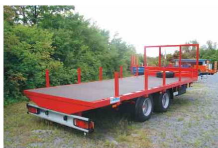
Ladungssicherung mit Steckungen und Stirnwanderhöhung aus Welldraht
