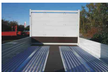
Stirnwanderhöhung als Aluminium, Gleitschutzrost auf der Ladefläche
