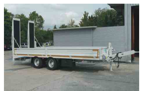
Spezieller Gummi-Belag auf den Rampen
