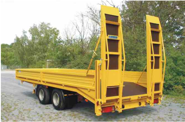
Ges.-Gew. 18000 kg , Bestellnr. 688/18000, NL ca. 14000 kg, Lademaß ca. 6200x2450 mm, Ladehöhe unbeladen ca. 980 mm, zwillingsbereift, Zubehör: steckbare Eckpfosten hinten
