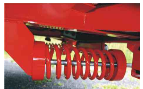
Rampenfederhebework anstelle Gasdruckdämpfer
