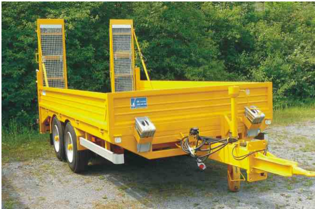
Ges.-Gew. 5000 kg , BestellNr. 645/5000, NL ca. 3450 kg, Lademaß ca. 4000x2300 mm, Ladehöhe unbel. ca. 810 mm, Zubehör: starre Zugdeichsel, Rampenbelag Gitterrost, Unterfahrtschutz seitlich, Eckpfosten steckbar
