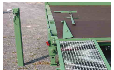
Eckpfosten abnehmbar - für maximale Auffahrbreite
