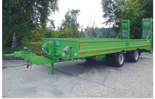
Ges.-Gew. 21000 kg , Bestellnr. 687/21000, NL ca. 16800 kg, Lademaß ca. 6200x2450 mm, Ladehöhe unbeladen ca. 1020 mm, zwillingsbereift, Achsabstand > 1,80 m, Zubehör: Rampen verlängert, klappbar, Gitterrostbelag,
