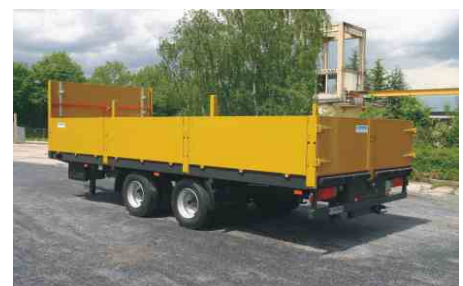
Sonderfahrzeug: erhöhte Alu-Seitenbordwände, Flügeltür, erhöhte Stirnwand
