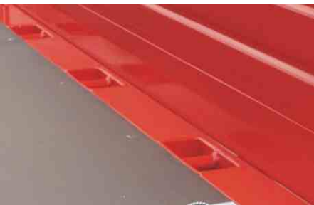
Zusätzlich Zurrkästen 4000 daN im Seitenprofil eingearbeitet
