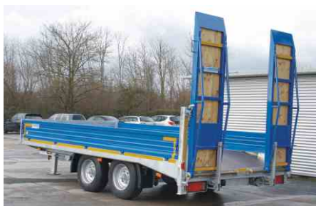
Chassis und Stirnwand im Tauchbad feuerverzinkt anstelle lackiert
