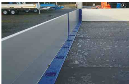
Zusätzliche Zurrmulden 2500 daN im Seitenprofil eingearbeitet
