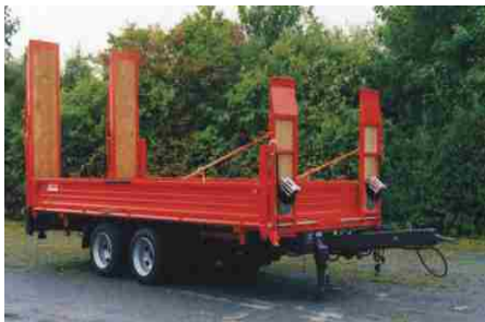
Überfahrampen mit 3,5to Traglast/Pair vorne, zur Überfahrt auf das Zugfahrzeug, hydraulisch verstellbarer Zugbaum
