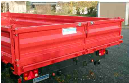
Rückbordwand als zweiteilige Flügeltür
