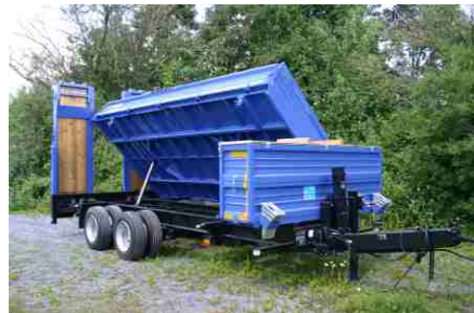
Staukasten 1 m 3 für kleinere Gerätschaften, abschließbar
