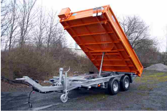
Ges.-Gew. 5000 kg , Bestellnr. 845/5000, NL ca. 3100 kg, Lademaß ca. 4000x2300 mm, Ladehöhe unbeladen ca. 850 mm, Zubehör: Chassis verzinkt, Werkzeugkiste
