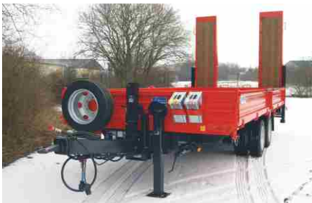
Ersatzrad und Halter an der Stirnwand
