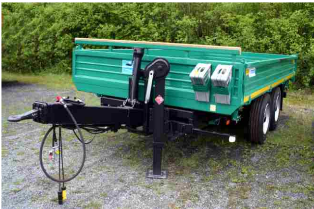
Ges.-Gew. 8900 kg , Bestellnr. 863/8900, NL ca. 6450 kg, Lademaß ca. 4500x2300 mm, Ladehöhe unbeladen ca. 880 mm, Zubehör: Auflagebock für Raupen- und Baggerschaufel
