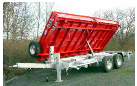
Chassis im Tauchbad feuerverzinkt
