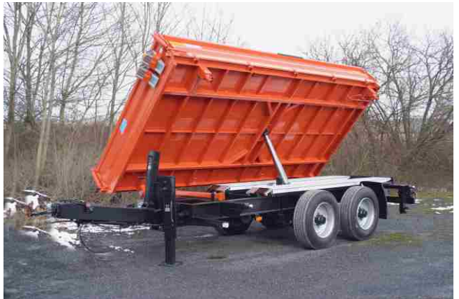
Ges.-Gew. 14000 kg , Bestellnr. 888/14000, NL ca. 11000 kg, Lademaß ca. 4500x2420 mm, Ladehöhe unbeladen ca. 1100 mm
