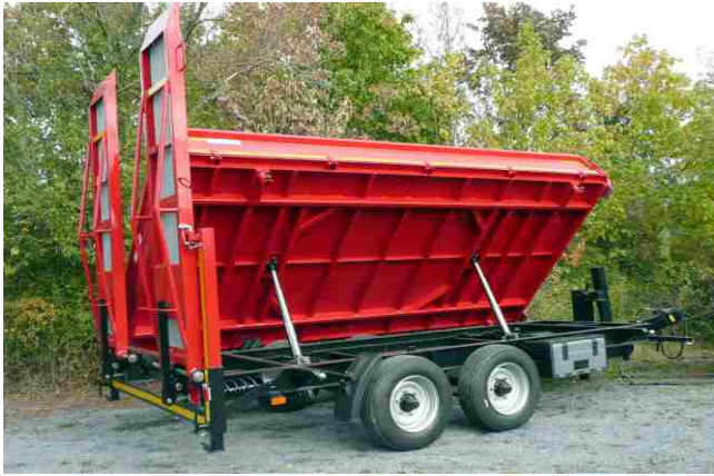
Ges.-Gew. 10500 kg , Bestellnr. 893/10500, NL ca. 7400 kg, Lademaß ca. 5000x2420 mm, Ladehöhe unbeladen ca. 930 mm, einfachbreit; Zubehör: Rampenbelag verzinkte Gitterroste, Werkzeugkasten
