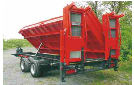
Rampenverlängerung auf 3,00m, 1 x klappbar, mit verstärktem Federhebewerk, Rampen mit verz. Gitterrosten anstelle Holzbelag
