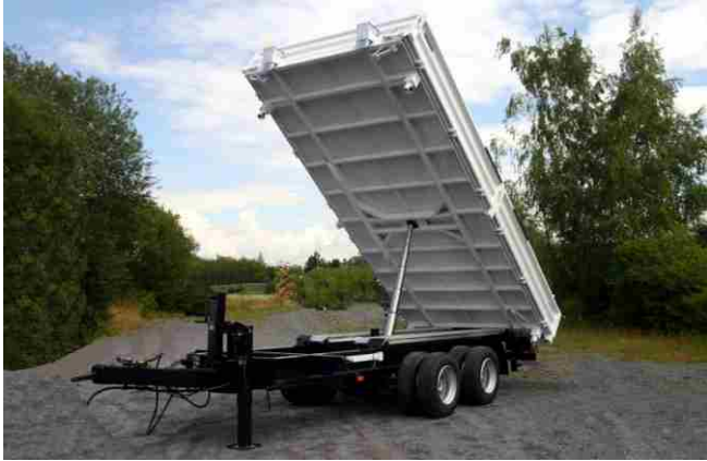
Ges.-Gew. 14000 kg , Bestellnr. 887/14000, NL ca. 10750 kg, Lademaß ca. 4500x2420 mm, Ladehöhe unbeladen ca. 1040 mm, zwillingsbereift
