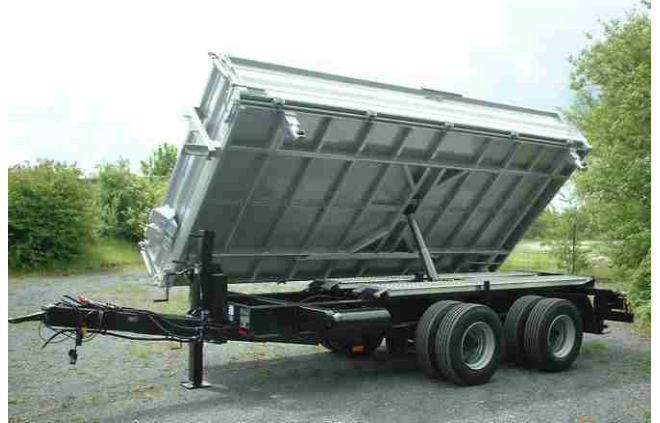
Ges.-Gew. 18000 kg , Bestellnr. 889/18000, NL ca. 14000 kg, Lademaß ca. 5000x2420 mm, Ladehöhe unbeladen ca. 1110 mm, zwillingsbereift, Zubehör: Federheber für Seitenwände, Bordwände 50 cm hoch
