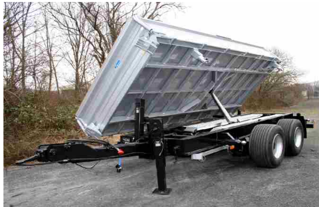
Ges.-Gew. 18000 kg , Bestellnr. 890/18000, NL ca. 13900 kg, Lademaß ca. 5000x2420 mm, Ladehöhe unbeladen ca. 1100 mm, Bereifung 385/65R22,5, Zubehör: Schwenköse, Baggerschaufelablage, Bereifung 435/50R19,5
