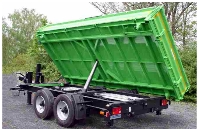
Ges.-Gew. 10500 kg , Bestellnr. 885/10500, NL ca. 7850 kg, Lademaß ca. 4500x2300 mm, wahlweise 4500x2420 mm, Ladehöhe unbeladen ca. 930 mm
