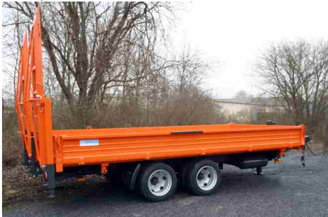
Ges.-Gew. 11900 kg , Bestellnr. 895/11900, NL ca. 8650 kg, Lademaß ca. 5000x2420 mm, Ladehöhe unbeladen ca. 870 mm, zwillingsbereift
