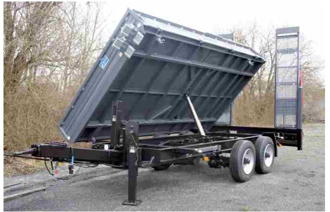
Ges.-Gew. 11900 kg , Bestellnr. 892/11900, NL ca. 8750 kg, Lademaß ca. 5000x2420 mm, Ladehöhe unbeladen ca. 930 mm, einfachbreit
