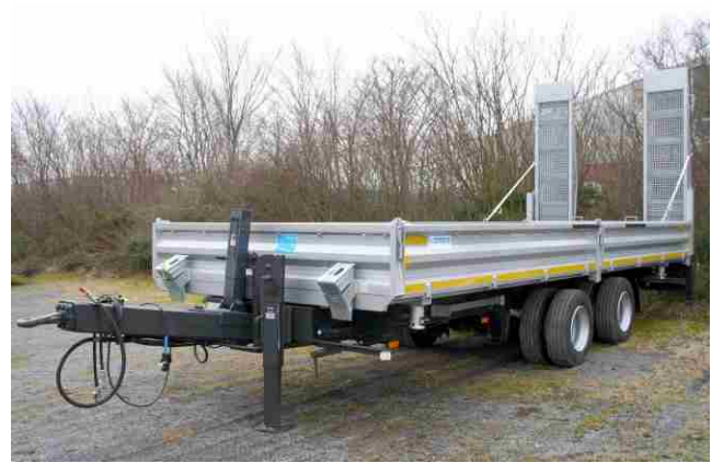
Ges.-Gew. 18000 kg , Bestellnr. 899/18000, NL ca. 13600 kg, Lademaß ca. 5000x2420 mm, Ladehöhe unbeladen ca. 980 mm, Zubehör: geteilte Bordwand, steckbare Mittelrunge, Rampenbelag Gitterrost, Netzhaken
