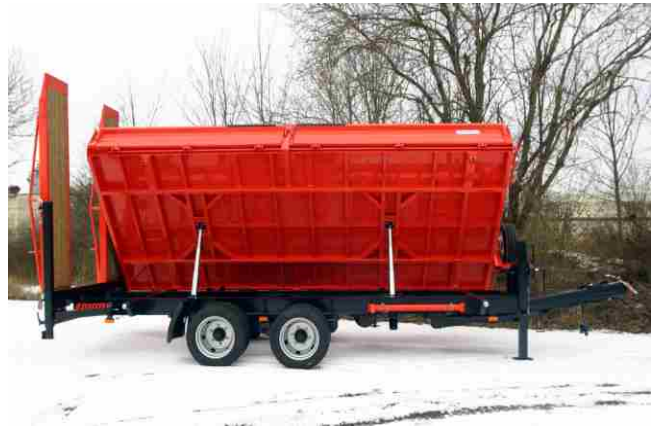
Ges.-Gew. 10500 kg , Bestellnr. 894/10500, NL ca. 7300 kg, Lademaß ca. 5000x2420 mm, Ladehöhe unbeladen ca. 870 mm, zwillingsbereift, Zubehör: Ersatzrad und Halter, geteilte Bordwand, steckbare Mittelrungen
