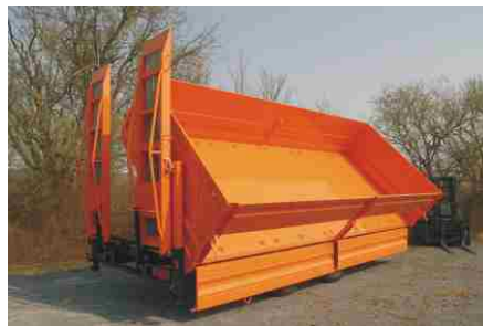
Alu-Aufsatzbordwände, zusätzliche Zurrmulden im Anhängerboden, Ladeflächenverlängerung auf 6,50m, Netzhaken
