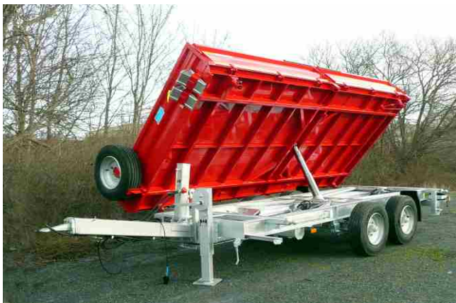
Ges.-Gew. 11900 kg , Bestellnr. 884/11900, NL ca. 9200 kg, Lademaß ca. 4500x2300 mm, wahlweise 4500x2420 mm, Ladehöhe unbeladen ca. 930 mm, Zubehör: Chassis feuerverzinkt, Ersatzrad und Halter
