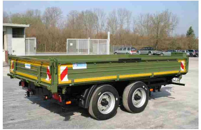
Ges.-Gew. 6900 kg , Bestellnr. 852/6900, NL ca. 4550 kg, Lademaß ca. 4000x2300 mm, Ladehöhe unbeladen ca. 880 mm, Zubehör: Warnstreifen, Werkzeugkiste, Netzhaken
